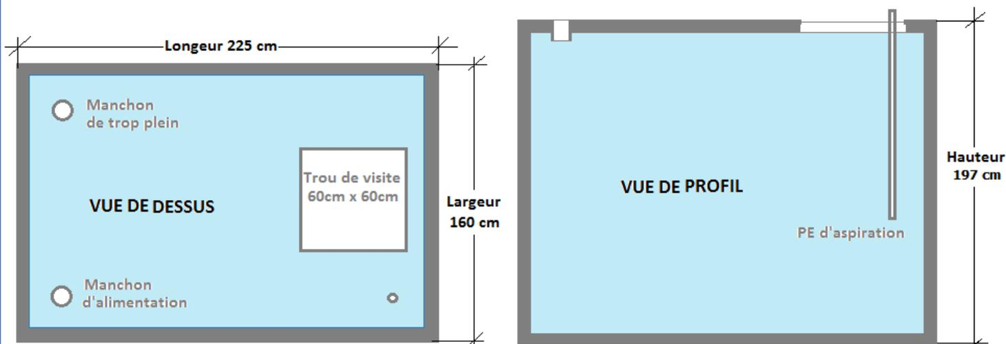
Cuve à enterrer de **3,3 tonnes**, fabriquée en béton hydrofugé de qualité supérieure, armé de feuilles de treillis soudé.
